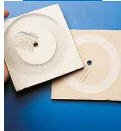
Abrasion Taber eseguita su Ultraplan (provino di destra) e rasatura convenzionale (provino di sinistra) dopo 200 giri
